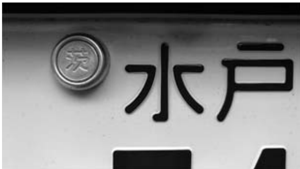
図1 封印取付け状況
